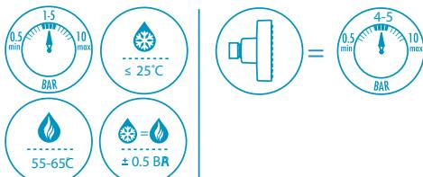
Не рекомендується застосовувати терmostатичний змішувач разом з проточними газовими і електричними водопідігрівачами.
