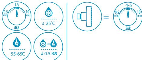
Nie zaleca się stosowania baterii termostatycznej wraz z przepływowymi gazowymi i elektrycznymi podgrzewaczami wody.
